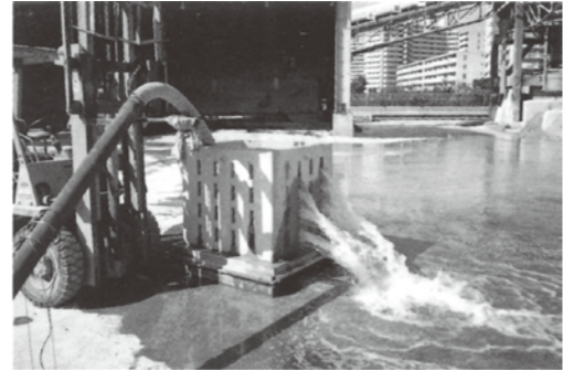
製品の浸透試験、噴流状況
